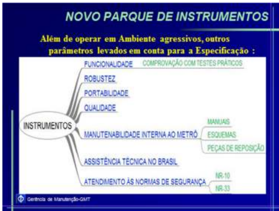
Fig.15 Parâmetros para a Especificação do Novo parque de Instrumentos.
