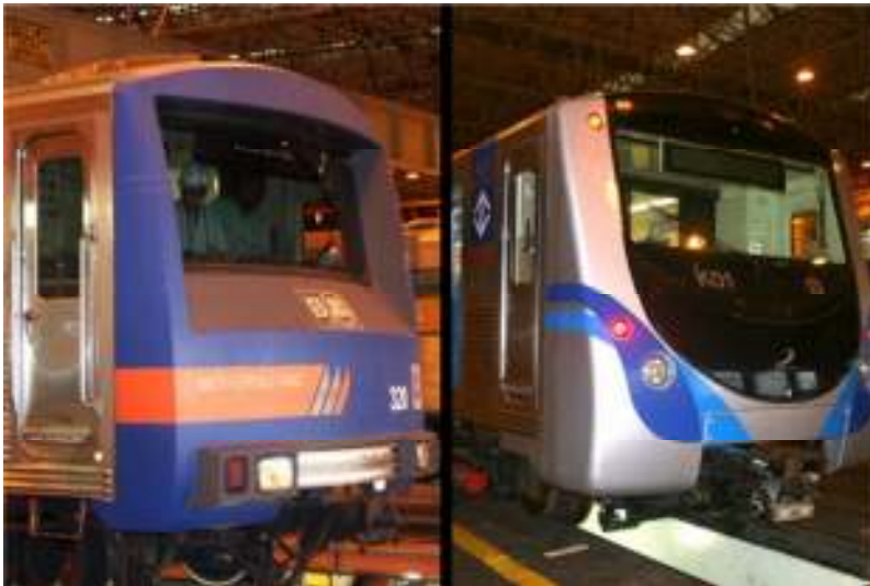
Fig.1 Trem antes e depois da modernização; Foram instalados Rádios digitais, 10 redes de dados e vídeo e 26 câmeras a bordo de cada trem, substituídos os sistemas de propulsão e freios.
