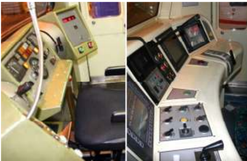
Fig.2 Cabine antes e depois da modernização
