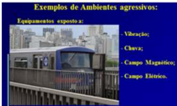
Fig.9 Exemplo de ambiente agressivo inerente às instalações do Metrô.
