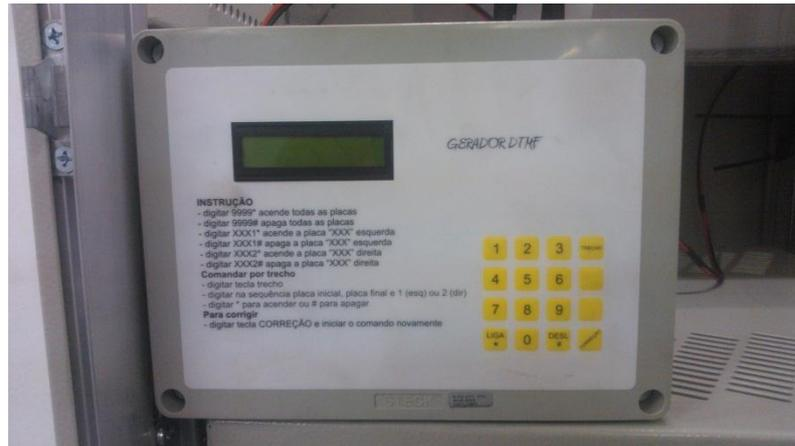
Figura 6 – Módulo Gerador DTMF existente.
