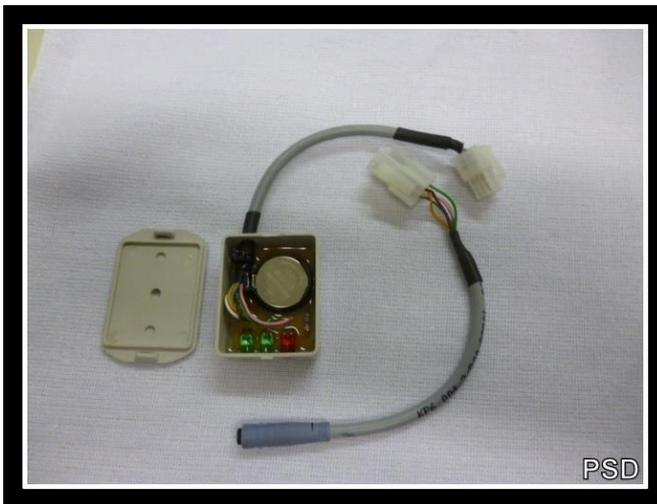
FIG.23 B – Instrumento de Calibração do Sensor.
