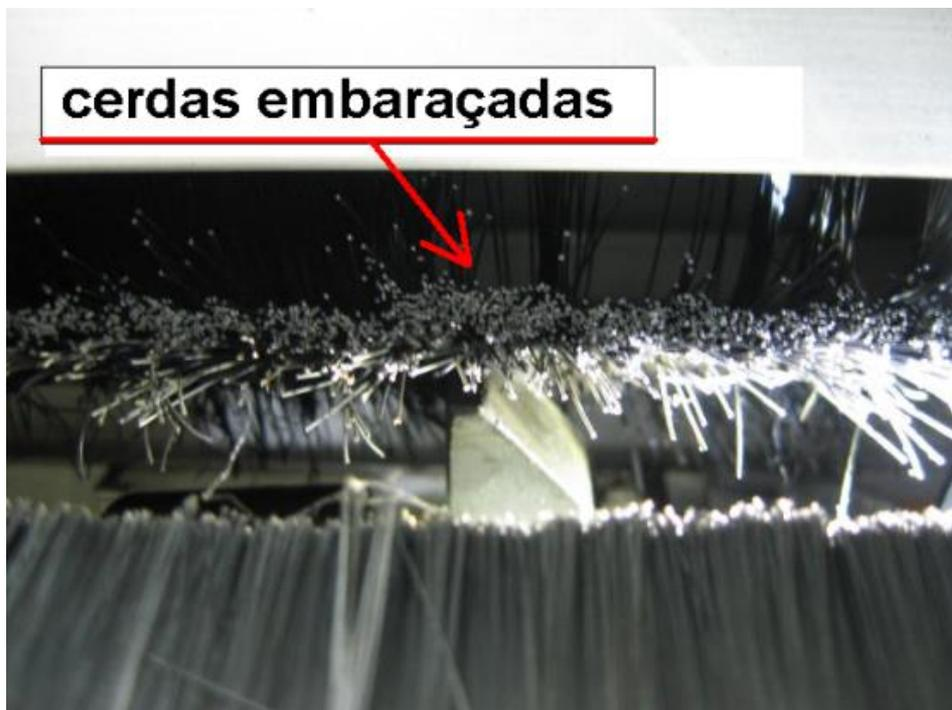
FIG.11–Detalhe Atrito da escova com o trinco
