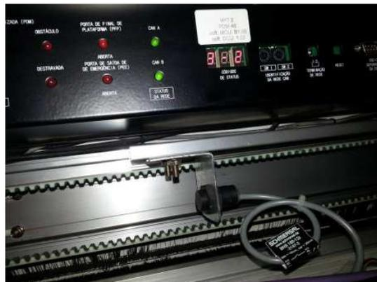
FIG.20B–Suporte de fixação modificado.
