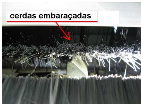
FIG.11–Detalhe Atrito da escova com o trinco
