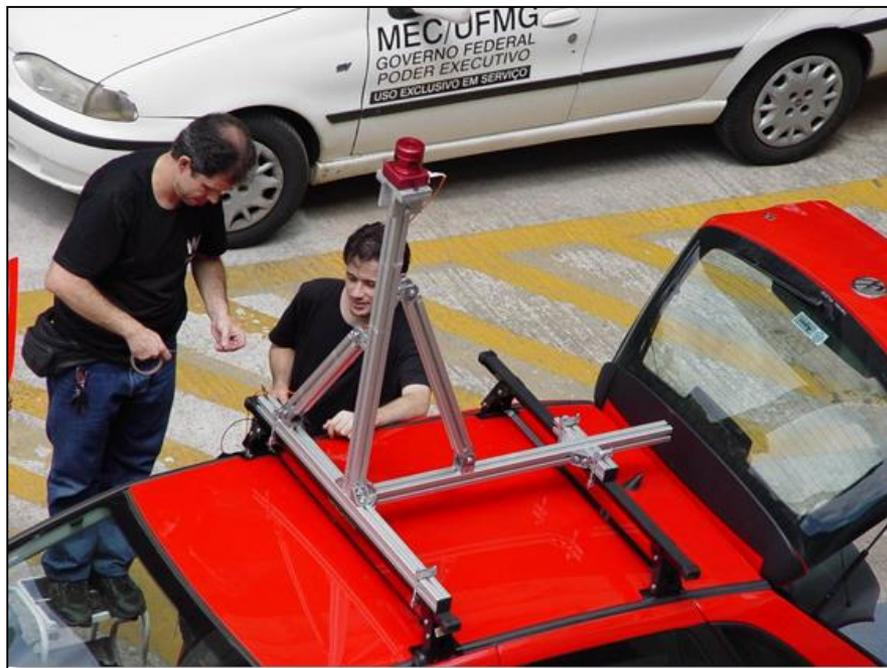
✓ Equipamentos de imagem utilizados: câmera de visão esférica Lady Bug (6 câmeras) da Point Grey Research, filmadora Sony Full HD e câmera Sony de alta resolução com sistema de GPS integrado.
