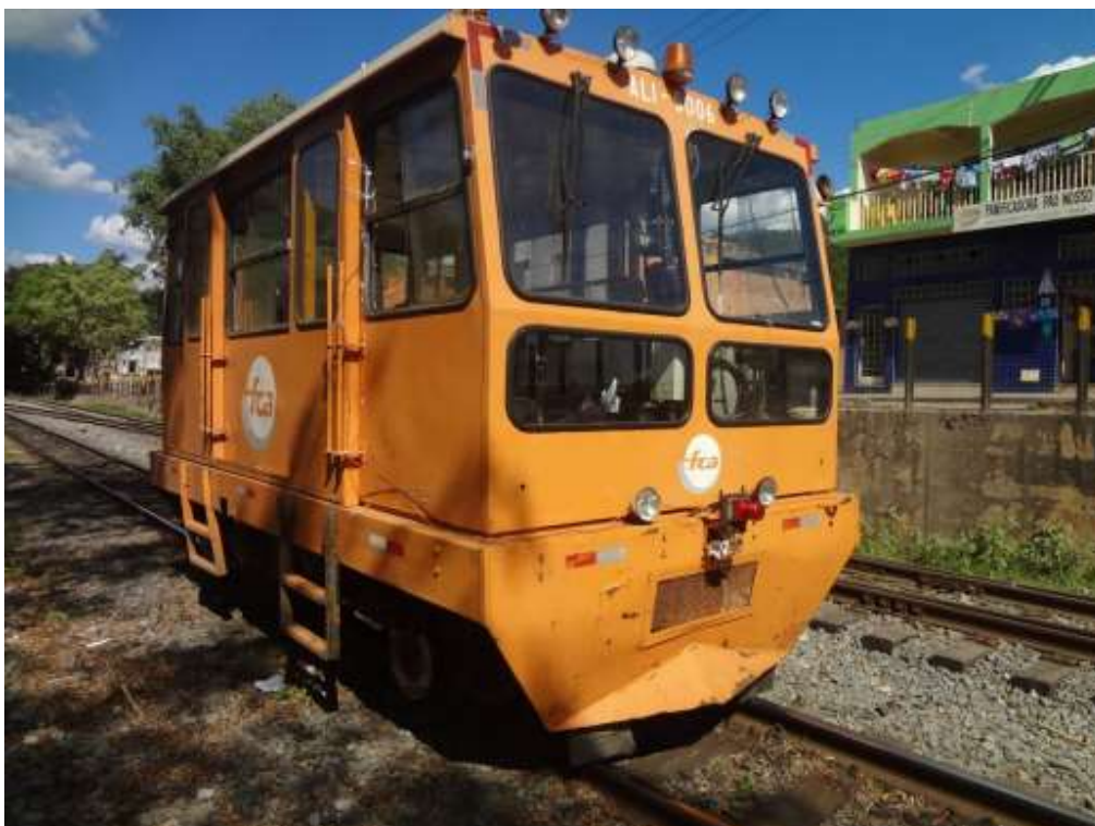
Figura 3 – Sistema de câmeras 360° instalado em auto de linha
