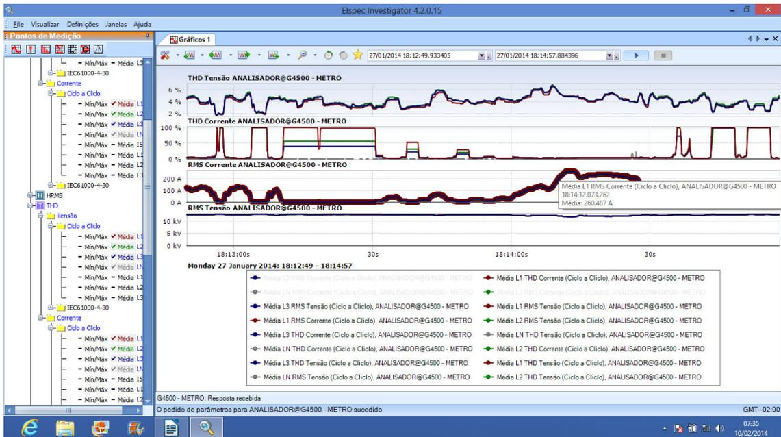
Figura 29 – Medição com AQEE ELSPEC BlackBox G4500, classe A, na estação Carrão (27/01/2014). Momento do registro da falha ocorrendo na estação. Pico médio de corrente = 260 A ocorrido as 18:14 horas
