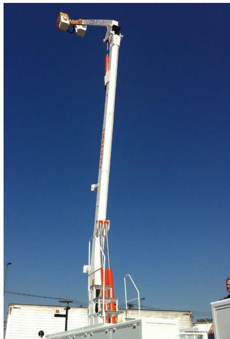
Figura 19 – Equipamentos para Trabalho em Altura: Detalhe do uso da Plataforma Elevatória no Pátio de Manutenção Itaquera (fig. esquerda no alto). Novo caminhão Cesta Aérea para profissionais da manutenção.
