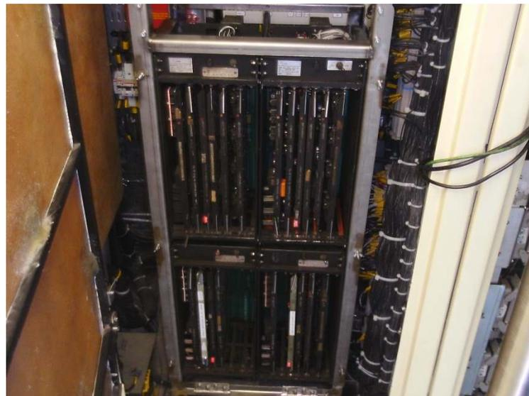
ATC-8080M montado no armário elétrico do trem L-31
