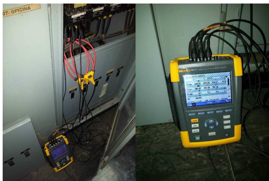
Figura 6 – Detalhes da medição da tensão e corrente do sistema de iluminação.
