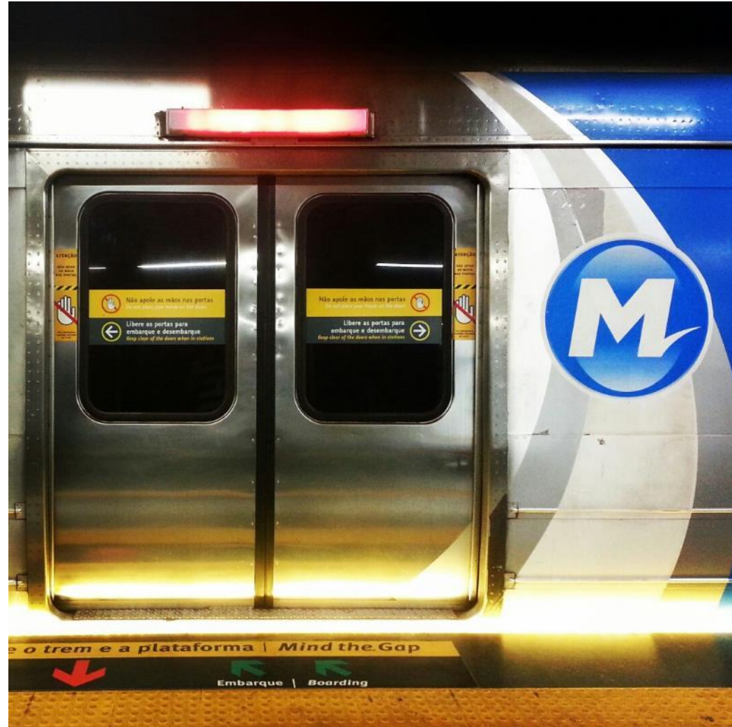
Trem do METRÔRIO, em estação com Gap Filler Iluminados em funcionamento
