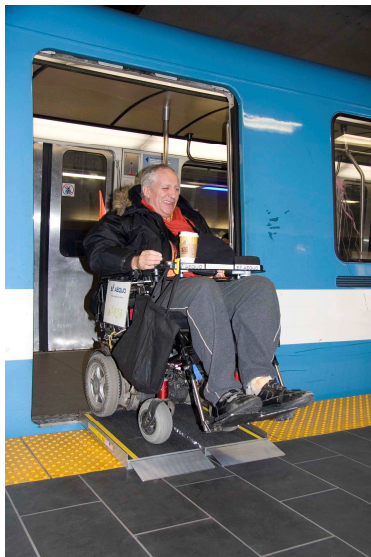
Figura 4 - Exemplo de solução de rampa retrátil para acesso de PNE em metrô da América do Norte (METRÔRIO, 2014).
