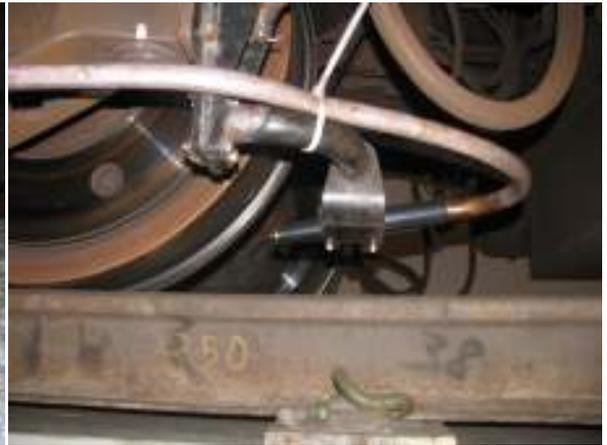
Figuras 1 e 2 – Sistemas de injeção de água e sabão nas rodas
