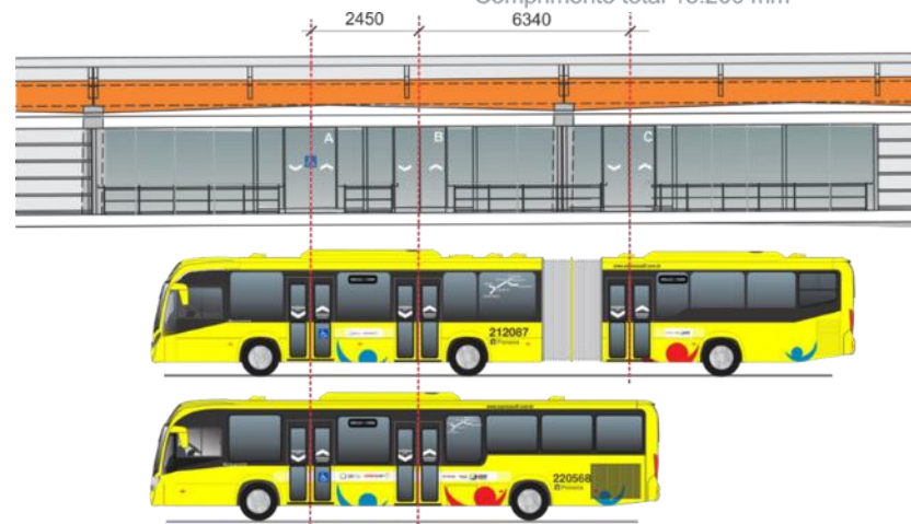
ÔNIBUS BÁSICO PISO BAIXO PARA BRT Low-entry Comprimento total 13.200 mm
