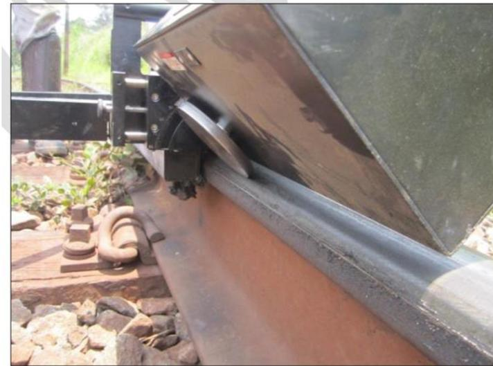
**Figura 2:** Medição do COF no canto do boleto no trilho externo das curvas
