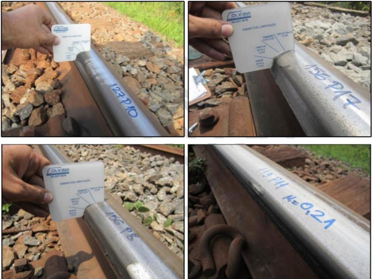
**Figura 21:** Filme de graxa na face do boleto varia conforme o tipo de contato.
