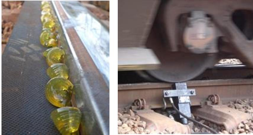
**Figura 1:** Exemplo de lubrificação na face da bitola
