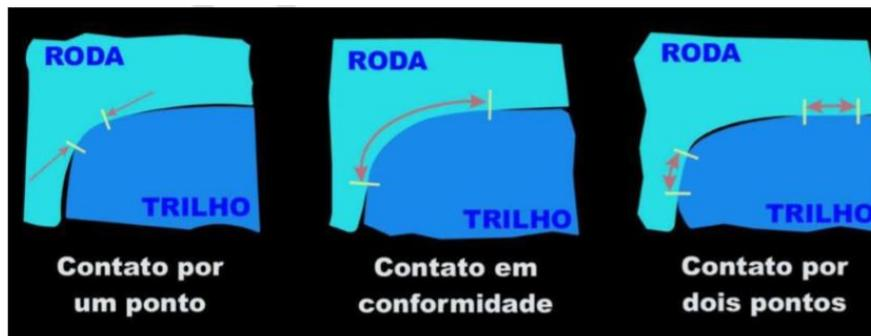
Figura 15: Tipos genéricos de contato roda-trilho
