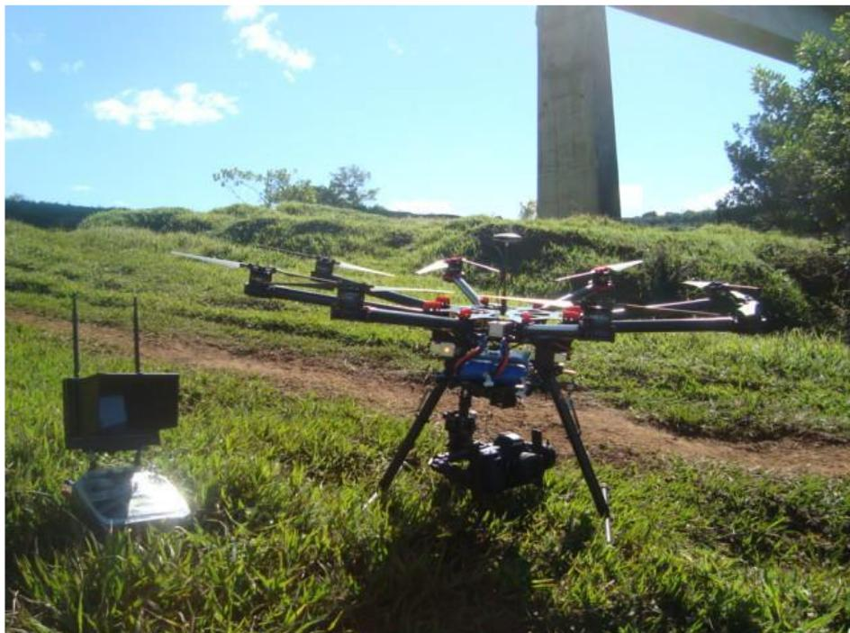
Figura 4 – Rádio controle com link de imagem, câmera acoplada ao drone.
