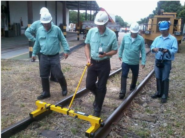
Figura 5 – Dispositivo “Amber” fornecido pela Geismar do Brasil em inspeção na região de Governador Valadares-MG.
