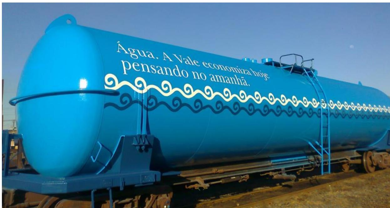
Pátio ferroviário de Costa Lacerda – Santa Bárbara / MG: Vagão TCD adaptado para armazenar 60 mil litros de água pluvial.
